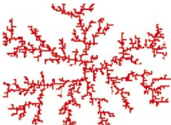
Рис. 3. Фрактальный агрегат, полученный в результате компьютерного моделирования диффузии частиц (модель Виттена–Сандера)
